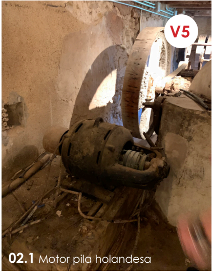
02. Restauració i sanejament dels elements d'acer de les màquines existents i els seus engranatges. En especial restauració (sanejament) del motor 02.1
